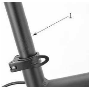
1. Oznaczenie maksymalnego wysunięcia wspornika
